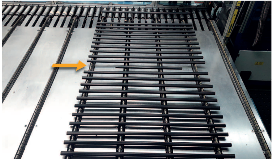
Das neue Steuerungsmodul SawControl von PIXARGUS integriert den Zuschnitt von Profilen in den Prozess der Qualitätssicherung. SawControl gibt der Schneidevorrichtung eine kontinuierliche Taktung für den Ablängungsprozess vor und schneidet fehlerhafte Profile in Unterlänge aus
