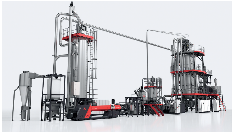
Starlinger präsentierte auf der K 2022 erstmals die neue recoSTAR PET art-Recyclinganlage für PET Bottle-to-Bottle-Anwendungen. Im Vergleich zum Vorgängermodell können damit rund 21 Prozent an Produktionskosten eingespart werden (©Starlinger)
