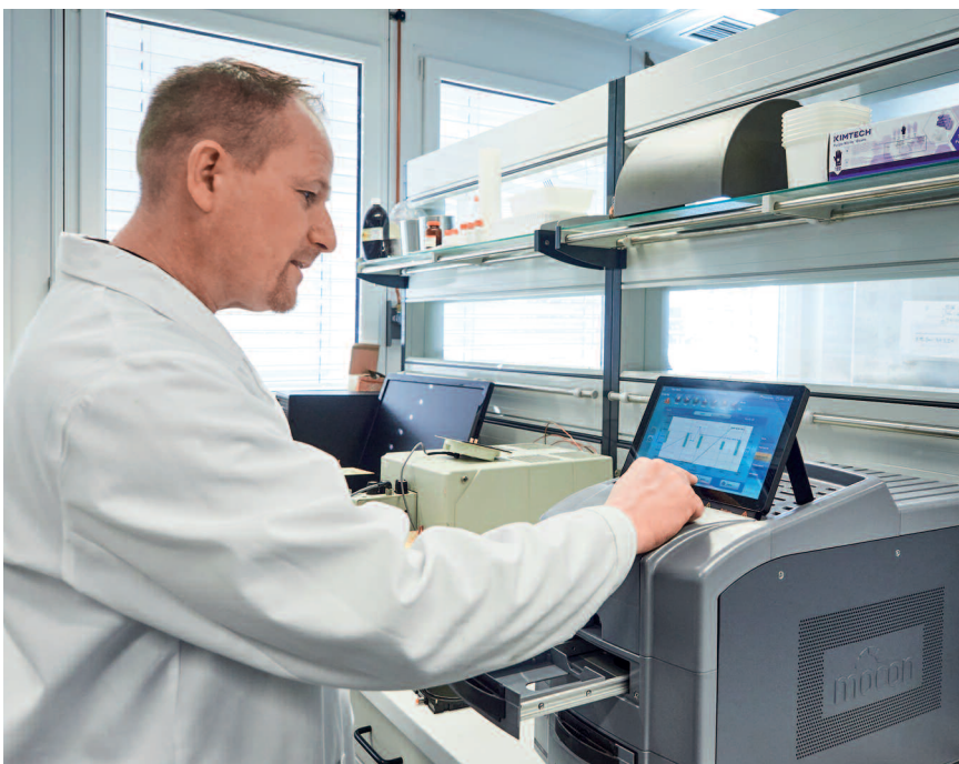
Michael Krainz, Experte am OFI im Bereich Verpackung & Lebensmittel, am Messgerät für Sauerstoffpermeation (©ACR_schewig-fotodesign)
