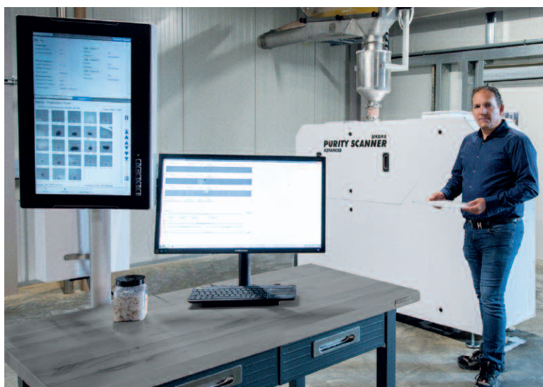
Lars Ruttmann, Geschäftsführer bei SORTCO, präsentiert den PURITY SCANNER ADVANCED von SIKORA zur Inspektion und Sortierung von Kunststoffgranulat
