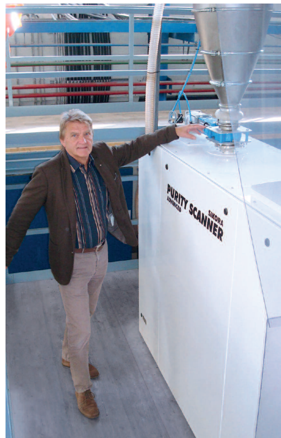
Minger setzt den PURITY SCANNER ADVANCED von SIKORA zur Inspektion und Sortierung von Kunststoffgranulat ein, Bruno Ofner, Geschäftsführer Minger Kunststofftechnik AG
