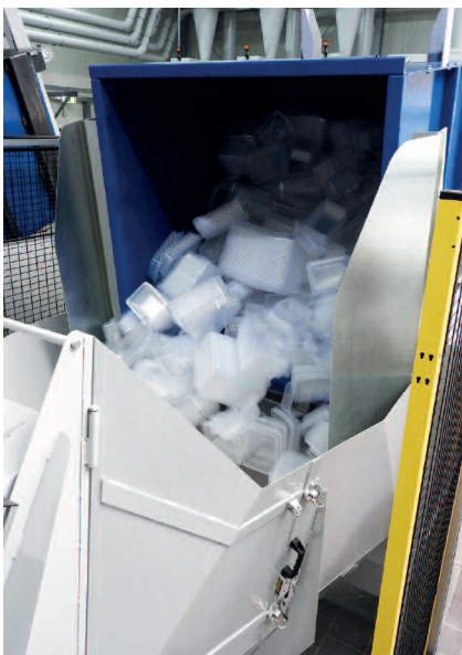
Die vollen Sammelbehälter mit den Thermoforming-Resten aus der Produktion werden vollautomatisiert in einen Übergabetrichter gekippt bis der definierte Entleerungsgrad erreicht ist. Unterstützend lässt sich ein integriertes Vibrationssystem zuschalten
