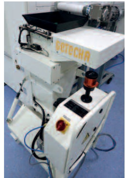
Eine universelle Premiumlösung für das Zerkleinern von Angüssen und Fehlteilen aus dem Spritzguss ist die Beistellmühle GRS 180, die Getecha auf der diesjährigen K präsentiert
