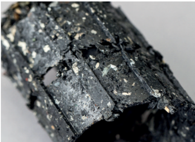
Bei minimalem Schmelzeverlust ist das Austragsgut hoch mit Fremdstoffen angereichert
