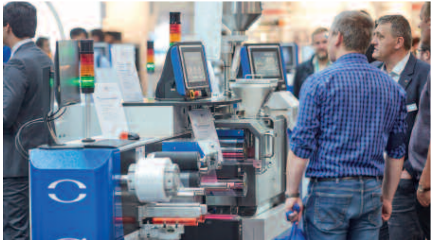
Mittels OCS Laborextrusionslinien wird der Polymerfilm inspiziert & analysiert
