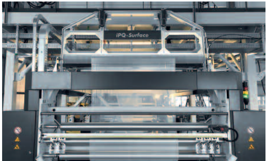
Das iPQ-SurfaceFILM ist das wirtschaftliche Oberflächeninspektionssystem für die Kunststofffolien mit intuitiver Bedienung und ausgezeichneten Ergebnissen
