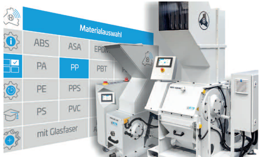
2019 auf der K erstmals vorgestellt, ist die digitale Smart-Control-Steuerung jetzt für das gesamte Portfolio der Schneidmühlen von Hellweg verfügbar (© Hellweg Maschinenbau)
