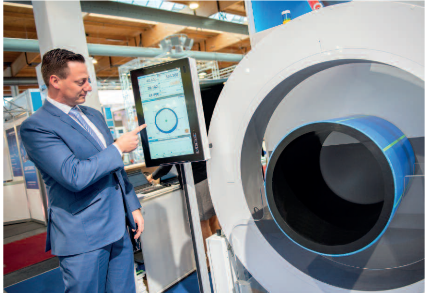
SIKORA zeigt auf der Fakuma das CENTERWAVE 6000 zur Qualitätskontrolle während der Rohrextrusion
