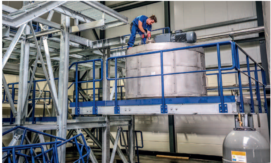
Lindners neuer PET-Hot-Wash-Tower für das qualitativ hochwertige PET-Recycling (Bilder: Lindner Recyclingtech)
