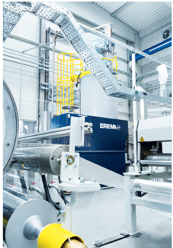
Alles in einem Arbeitsschritt: Das Inputmaterial gelangt vom MPR in das Extrusionssystem und wird im Anschluss direkt zu einem Inline Sheet Produkt verarbeitet
