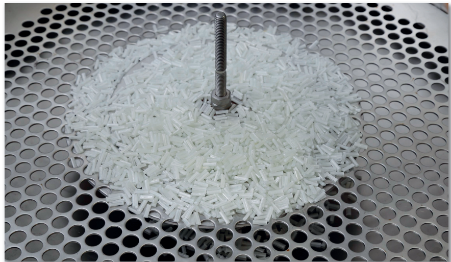
Die Leistungsfähigkeit seiner LFT-Pultrusionsanlagen zeigt ProTec am Beispiel selbst entwickelter innovativer Pellets aus langfaserverstärkten Thermoplasten
