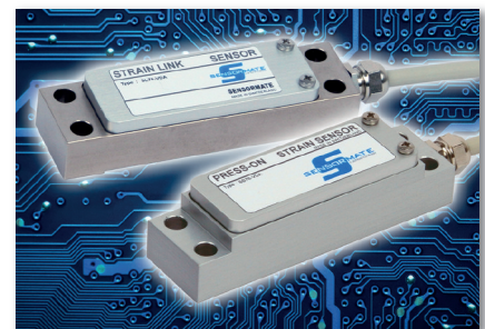
Die Dehnungssensoren SL76-VDA und SB76-VDA mit integriertem Verstärker verarbeiten das Signal direkt an der Montagestelle und eliminieren somit mögliche EMV-Probleme
