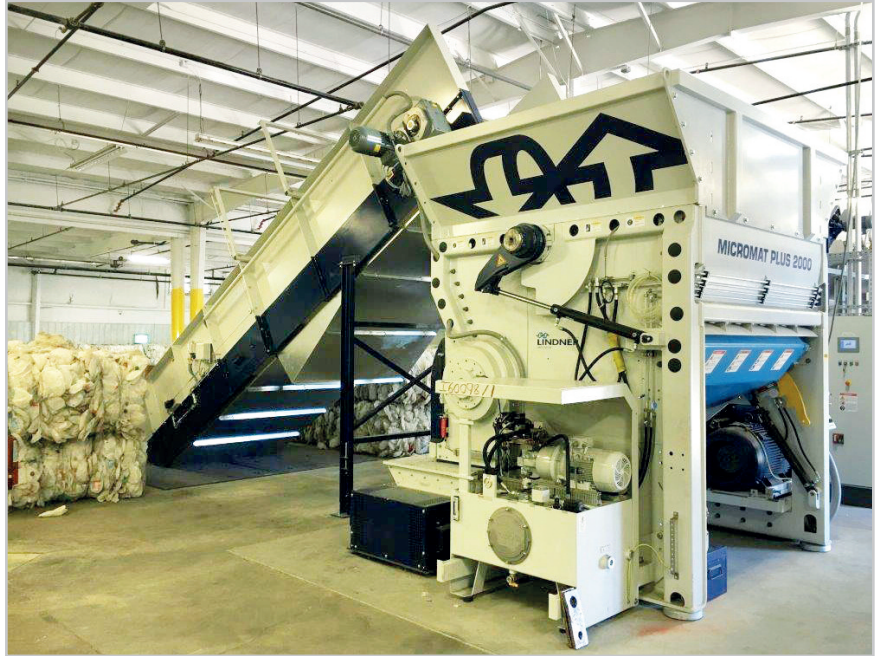
Der Einwellen-Vorzerkleinerer Micromat Plus 2000 von Lindner wird per Förderband mit den zu Ballen gepressten Einweg-Milchbehältern aus PE-HD beschickt
