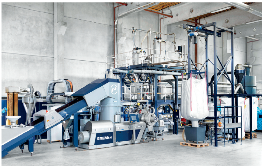
Premiere auf dem TecDay Recycling & Compounding: Die 2-stufige EdelweissCompounding-Anlage mit EREMA Aufschmelzextruder COREMA® bietet den Anwendern mehr Wirtschaftlichkeit
