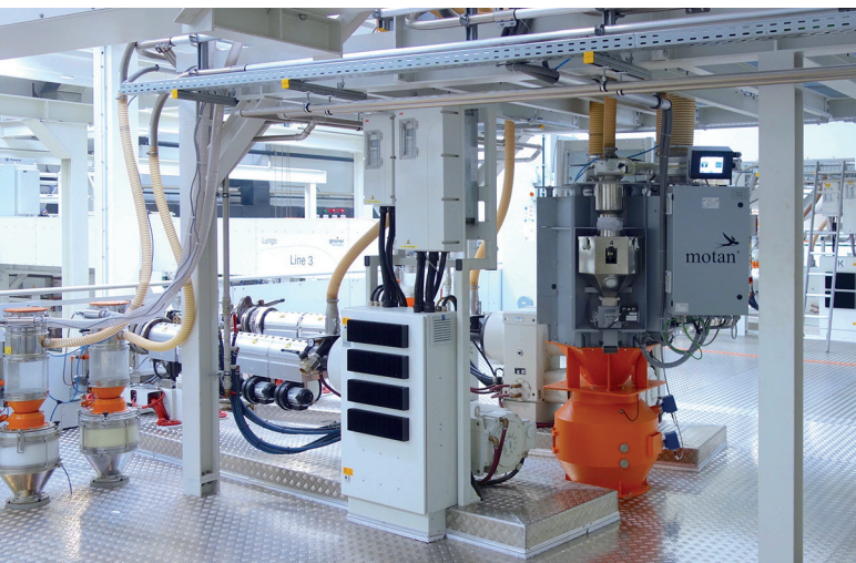
Bild 5: Zentrale Mischstation zur Versorgung des „Mahlgut-Extruders“. In ihr treffen vier Materialkomponenten (Mahlgut aus dem Silo oder aus dem Big-Bag, Stabilisator für den Haftvermittler und PP-Neumaterial) zusammen, die aus den gravimetrischen Dosiergeräten in der dritten Ebene zudosiert werden (Foto: Autor)
