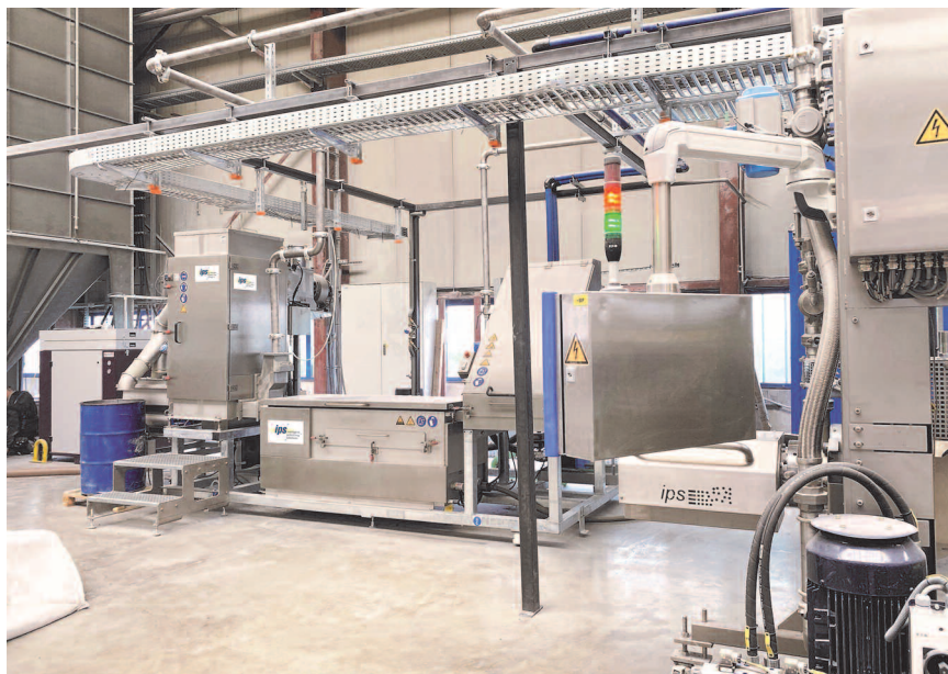
Mit dem neuen ips Unterwasser-Granuliersystem ips-UWG 120 S produziert RSH POLYMERE GmbH sehr hochviskoses Polyolefin
