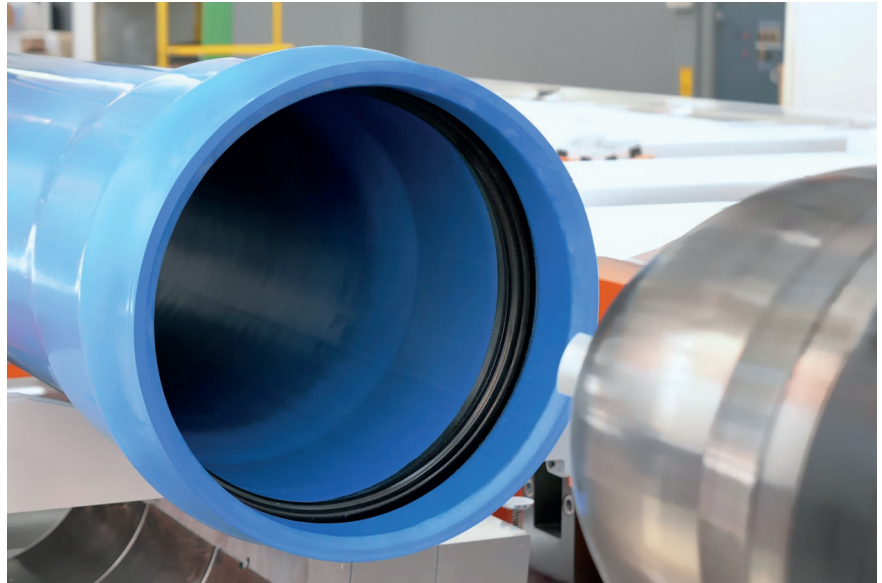
Rohr aus PVC-O DN315 PN25 ISO 16422 MRS500 mit SICA-Verfahren geformter Rieber-Muffe
