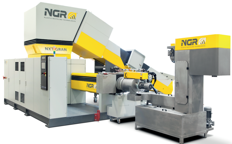
Shredder-Feeder-Extruder Kombination – Die NXT:GRAN vereint Zerkleinern, Zuführen und Extrudieren in einem einzigen, höchst effizienten Arbeitsschritt (ONE-STEP Technologie)
