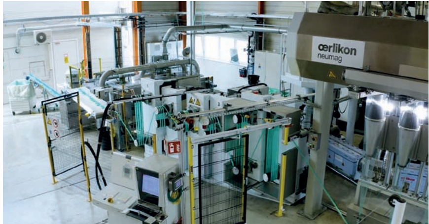
Im Technikum von IFG Asota in Linz laufen Versuche mit häufig wechselnden, auch biobasierten Faser-Rezepturen. Das Reinigungsgranulat Dreyclean trägt zum reibungslosen Betrieb bei und verringert Materialverluste beim Anlaufen der Anlage (Bild: IFG Asota)
