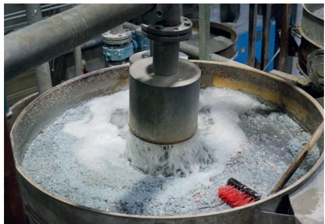
Waschen und Schreddern der PET-Abfälle mittels Heißwäsche bei 60 °C
