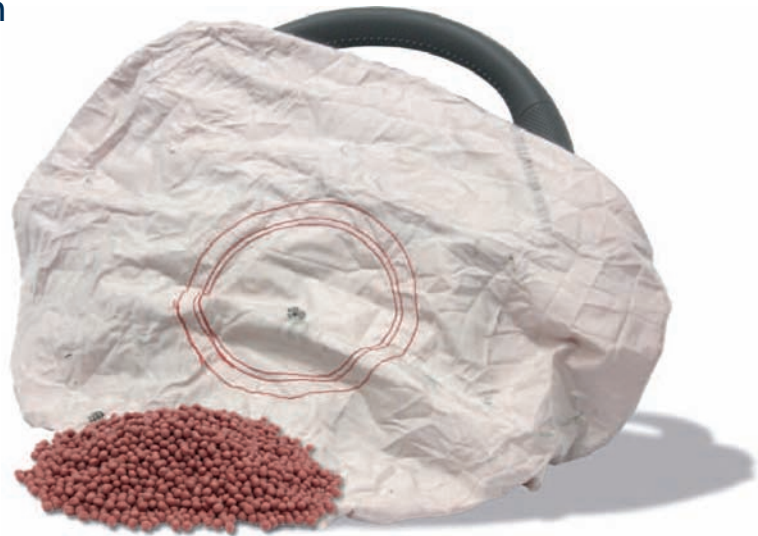
Silikonhaltige Airbagabfälle werden zu einem Rezyklat für technische Anwendungen reaktiv aufbereitet
