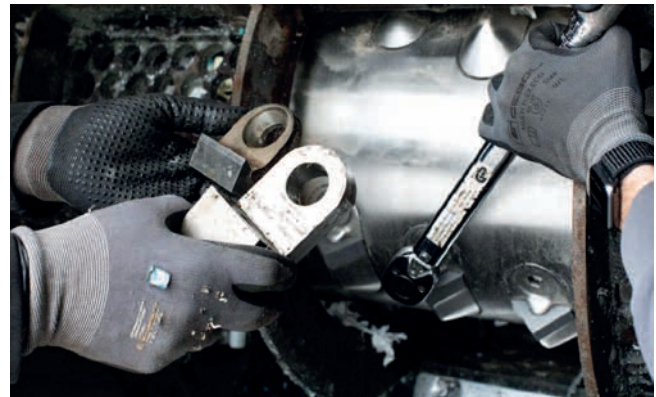
Die Kombination unterschiedlicher Messergeometrien ermöglicht eine optimale Anpassung an die zu zerkleinernden Kunststoffe
