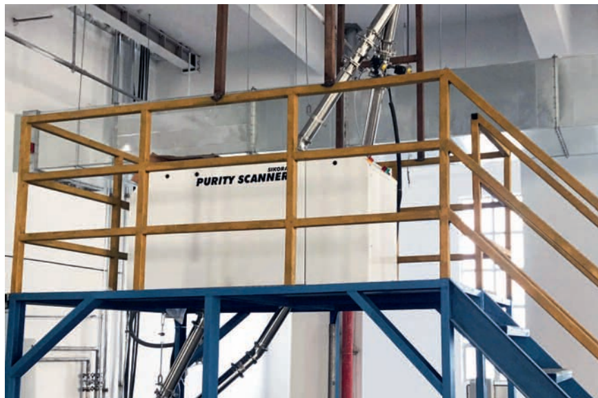
SIKORAs PURITY SCANNER ADVANCED installiert bei einem chinesischen Hersteller von HV-, EHV- und Seekabeln zur Inspektion und Sortierung von XLPE Granulat
