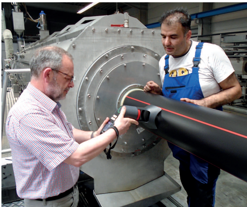
Das WARP portable im Einsatz bei WKT. Stefan Depmer, Leiter für Technik und Betrieb, und Türkayan Güneyik, Betriebsleiter PE, überprüfen die Wanddicke während der laufenden Rohrextrusion
