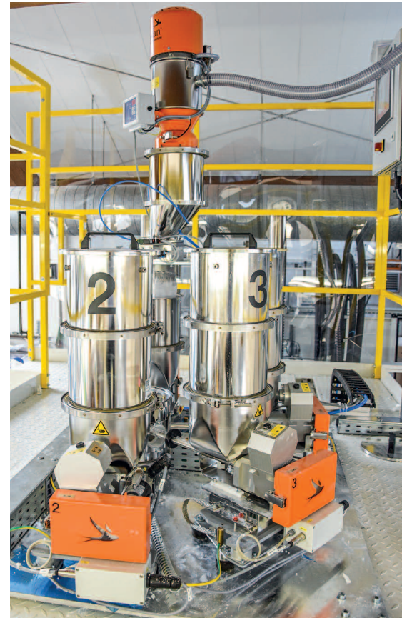
Das modular aufgebaute Dosiersystem lässt sich ohne großen Aufwand mit verschiedenen Dosiermodulen für Granulat, Mikrogranulat, Pulver und Mahlgut sowie für Flüssigkeiten schnell an unterschiedlichste Dosieraufgaben anpassen (Alle Bilder: motan-colortronic)
