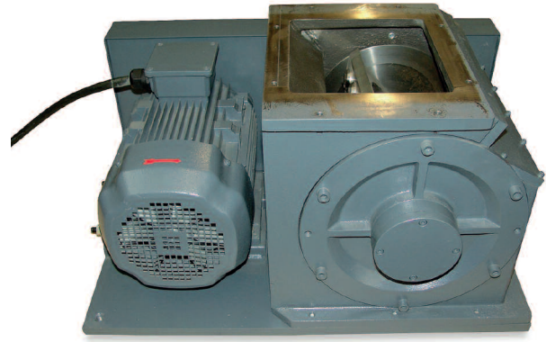
Der FS 300 hat eine Antriebsleistung von 3,0 kW und einen Rotordurchmesser von 300 mm. Er kommt meist für größere Anwendungen mit höheren Luftdurchsätzen von bis 6.000 m 3 zum Einsatz
