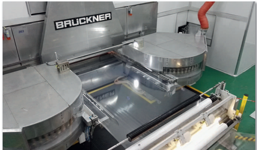
Erfolgreiche BOPA-Folienproduktion bei Xiamen Changsu auf einer simultanen Brückner-Anlage
