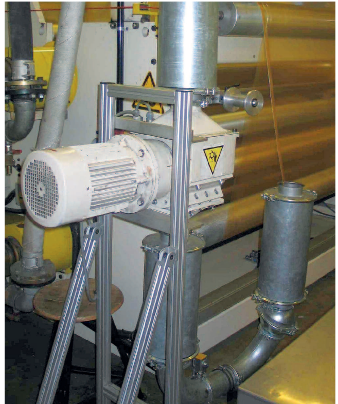
Die Getecha-Folienschneider – hier im Bild ein FS 200 – sind so konzipiert, dass sie sich spannungsfrei mit zwei Kompensatoren direkt in die Rohrleitung einer Absauganlage einbauen lassen (Alle Bilder: Getecha)
