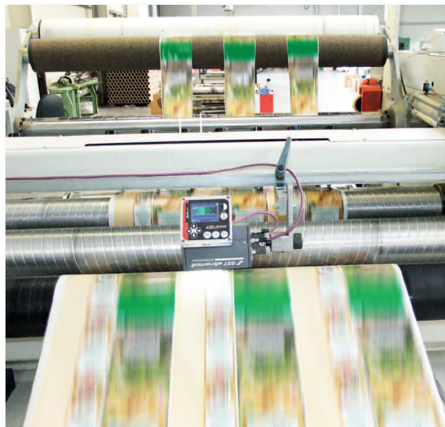
Im Rollenschneider ist besonders hohe Präzision gefordert. Diese stellt ein Linien- und Kontrastsensor CLS Pro 600 von BST eltromat sicher
