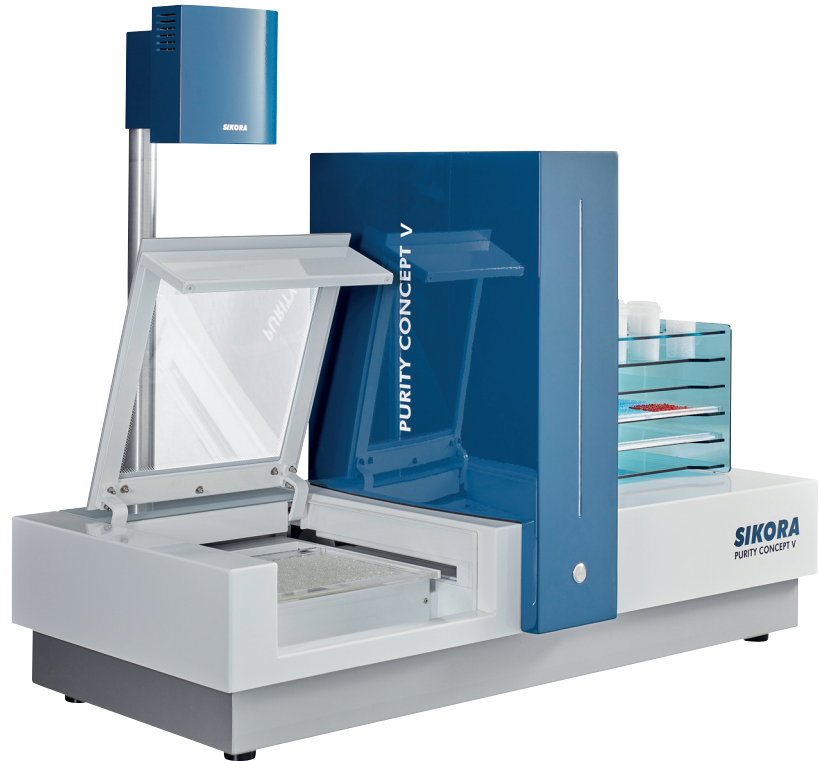
Bild 6: Automatisiertes Leuchttischsystem zur offline Inspektion und Analyse von Kunststoffmaterial
