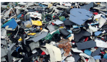
Bild 1: Kunststoff-Gemisch aus dem Elektronikschrott nach Zerkleinerungsanlage & Abtrennung der Metallfraktionen
