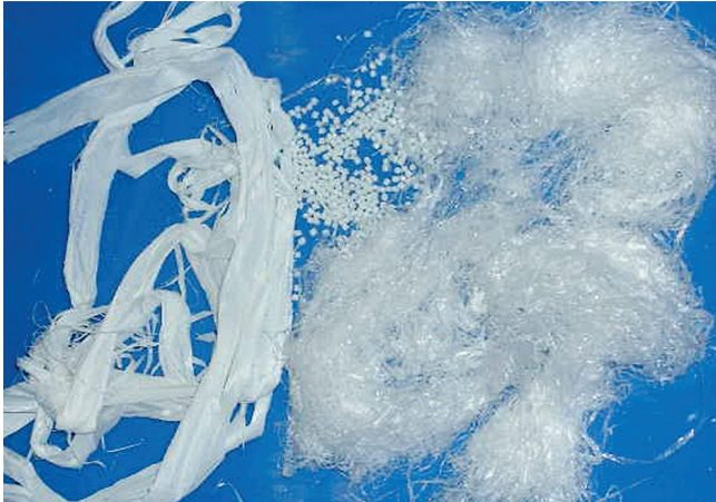
Reibungswärme führt vielfach dazu, dass sich Fäden („Engelshaar“; im Bild rechts) bilden oder sich aus Ablagerungen Filme („Schlangenhaut“) ablösen
