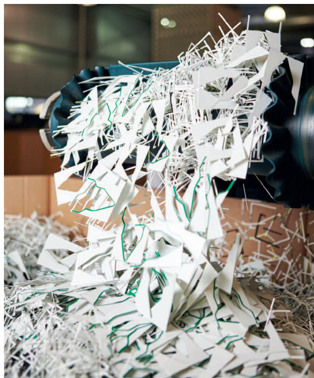
Bedruckte Stanzabfälle werden zu 100 Prozent wieder in den Kreislauf geführt (©Renner)
