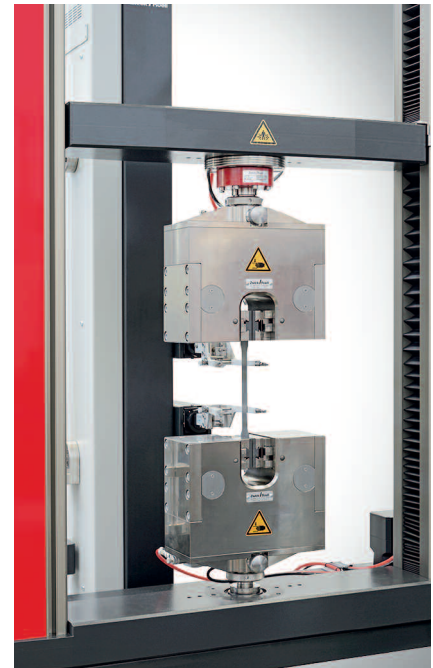
Die Messfühler des multiXtens II HP lassen sich für unterschiedliche Versuche leicht über einen Schnellverschluss wechseln (Bildquelle: ZwickRoell)
