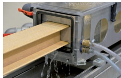
Die Extrusionslinie mit dem fiberEX 93-34D Extruder, auf der ein H-Profil gefahren wurde
