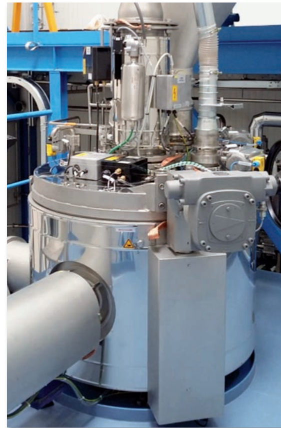
Vertikaler Schnellmischer der Flex®-line Baureihe von MTI (Bild © MTI Mischtechnik)
