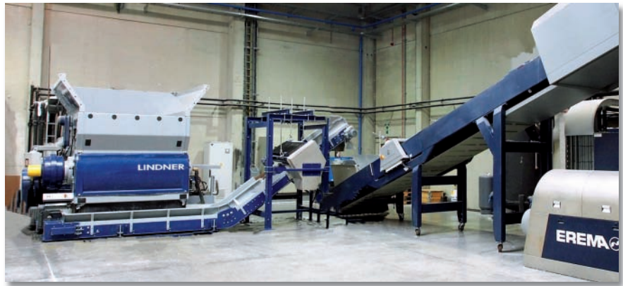
Der Verbund aus Micromat Plus 2000 und INTAREMA® 1714 TVEplus® im Einsatz bei Tivaco: Der dem Recycling-Extruder von Erema vorgeschaltete Shredder von Lindner bereitet die Ausgangsstoffe so auf, dass die Durchsatzleistung der nachfolgenden Extrusion um bis zu 15 Prozent gegenüber der Direktverarbeitung steigen kann
