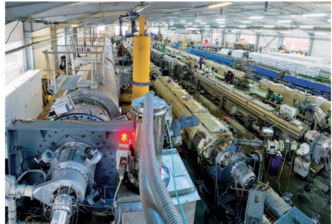
Ansicht der Produktionshalle von Tehno World mit der neuen 1,2 m Rohrextrusionslinie von battenfeld-cincinnati links im Bild View of Tehno World's production hall, with the new 1.2 m line from battenfeld-cincinnati on the left side (All photos © Tehno World)
