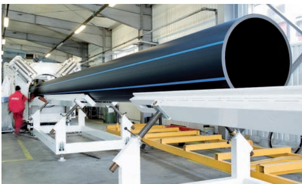
Auf der Linie von battenfeld-cincinnati hergestelltes Großrohr mit 1,2 m Durchmesser und Farbstreifen A 1.2 m pipe with color stripes produced on the battenfeld-cincinnati line
