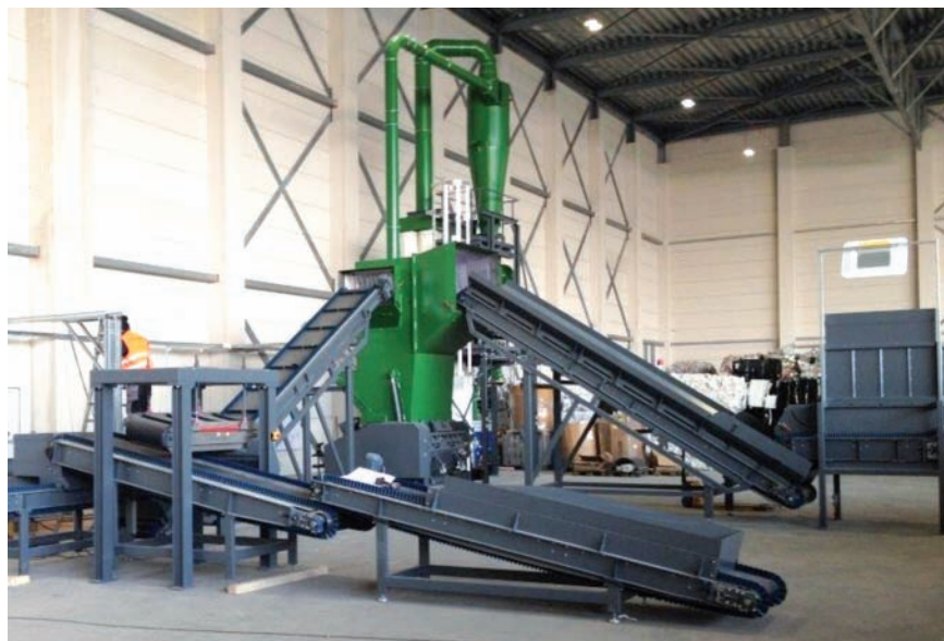
Zerkleinerungstechnische Gesamtlösung von Getecha: Die Roto-Schneider-Großmühle RS 6015 (grün) mit fördertechnischer Peripherie (grau) und Zyklonabscheider (grün) (Alle Bilder: Getecha GmbH)
