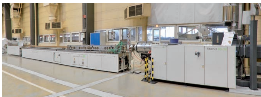
Die Extrusionslinie mit dem fiberEX 93-34D Extruder, auf der ein H-Profil gefahren wurde
