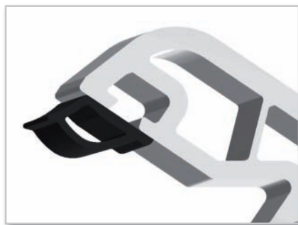
Aufextrudierte Dichtung Gaskets joined on by extrusion
