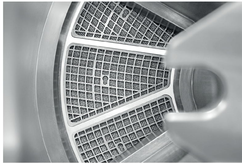
图1:格诺斯旋转过滤系统RSFgenius 带反冲洗功能的滤网转盘
